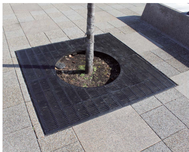
設置場所：千代田区 九段坂公園 品 番：TG-KM-1580FA サ イ ズ：外口1500mm 内φ800mm 連結部分が表面に出ない構造とし、ゴムキャップでカバーすることでフルフラットに。
